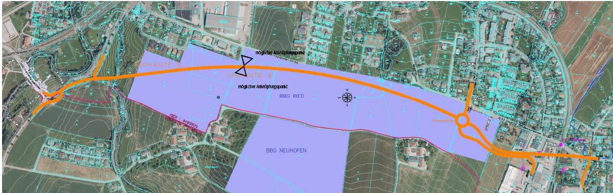
Die Variante 5 stellt grundsätzlich auf eine Länge von etwa 640 Metern eine Untervariante der Variante 4 dar. Ab Proj. km 0,8 entspricht die Variante 5 im gesamten Verlauf der Variante 4.
