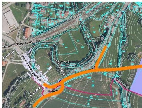
Danach verläuft die Variante mit gestreckter Linienführung Richtung Osten und durchschneidet dabei ein bereits gewidmetes Geschäftsgebiet. Im Anschluss wird der Baumbach etwa 90 Meter nördlich der übrigen Varianten gequert.
